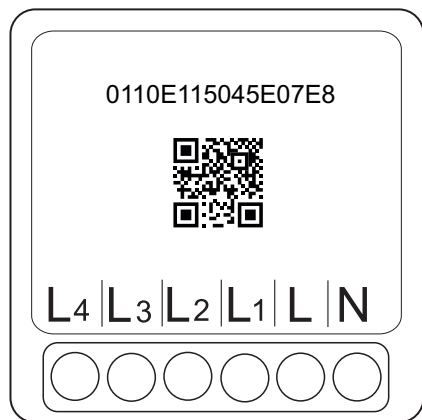
Рисунок №1. Входные контакты модуля расширения EXM/TT-001/LW
